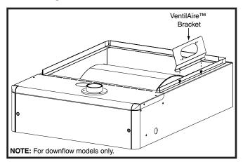
Figure 33. VentilAire<sup>™</sup> Bracket
