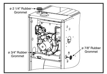
Figure 28. Rubber Grommets
